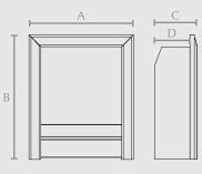
A) Width 512mmB) Height 607mmC) Depth 232mmD) Inset Depth 197mm
