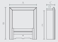
A) Width 512mm B) Height 611mm C) Depth 174mm
