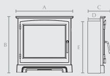
A) Width 668mm B) Height 672mm C) Depth 205mm
