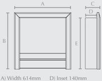
A) Width 614mmB) Height 611mmC) Depth 170mmD) Inset 140mmD) Rear Height 565mm
